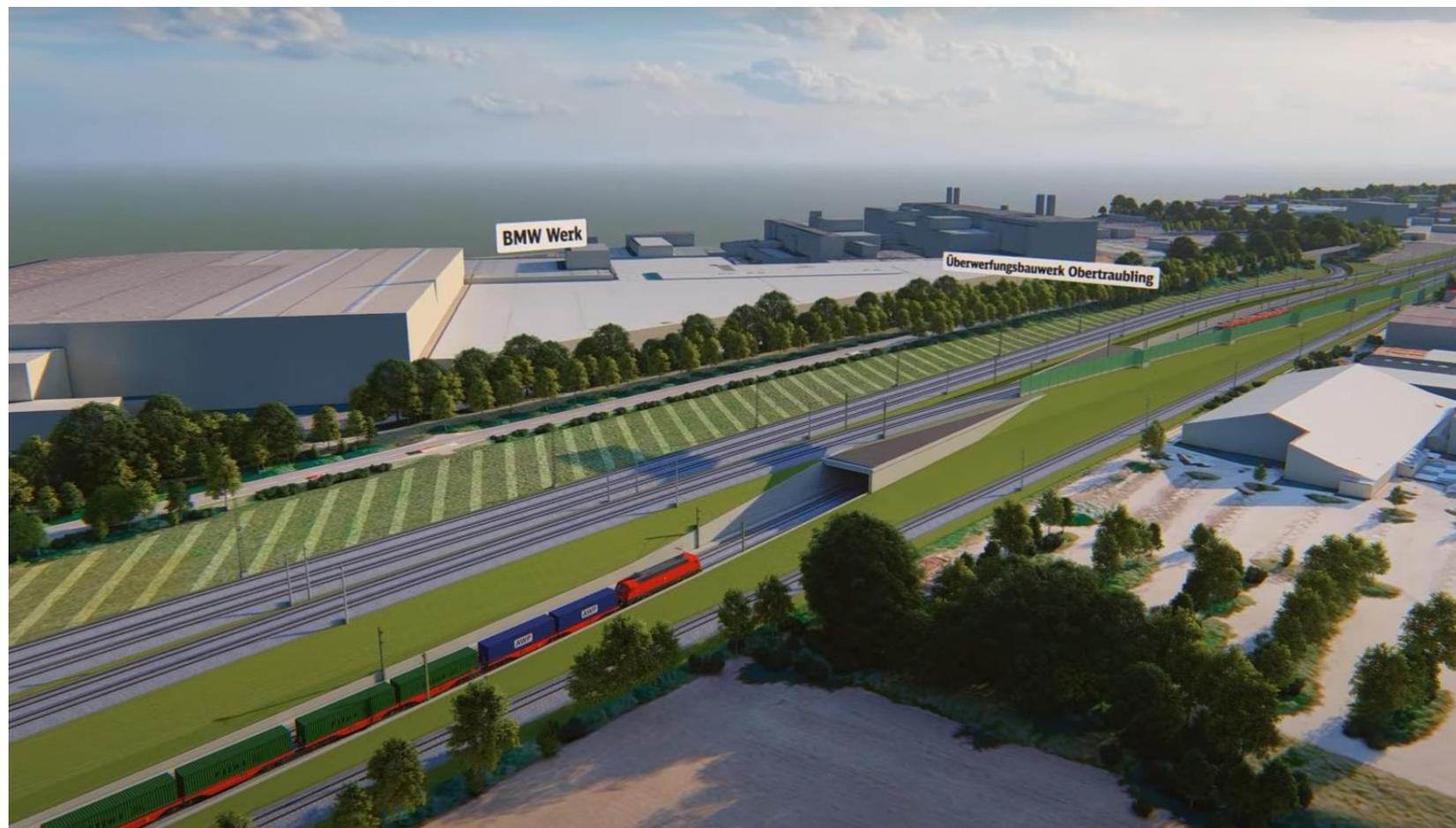
Zur höhenfreien Verknüpfung der Streckengleise von Ostkorridor (Schwandorf) und Regensburg/Hbf nach Passau und München wird ein 2-gleisiges Überwerfungsbauwerk errichtet. Die unteren Gleise werden zur besseren Integration in die Landschaft abgesenkt geführt.
